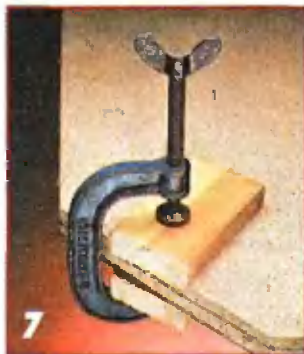
Чтобы не оставить вмятин на плите, под струбцины подкладывают деревянные брусочки.
