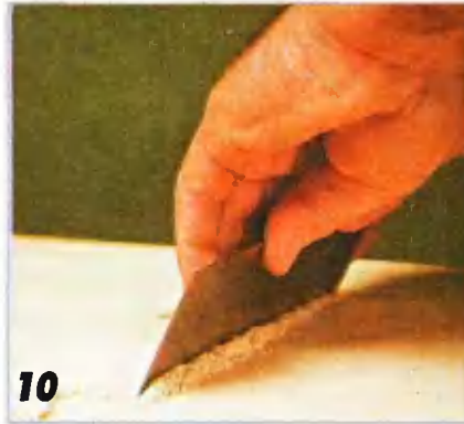
Цикля не только удаляет «гребни» между отстроганными за тот или иной проход участками, снимает поднявшийся древесный ворс, но и устраняет другие неровности.
