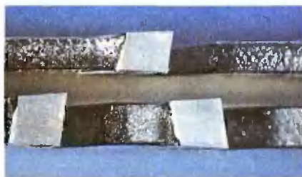
Чем тоньше диск, тем меньше древесины уходит в опилки.
