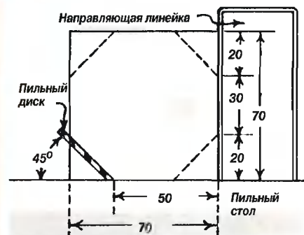
Рис. 2. Изготовление восьмигранного бойка.
