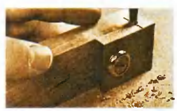
На линии стыка размечают центры сверлят отверстие Ø 6 мм.
