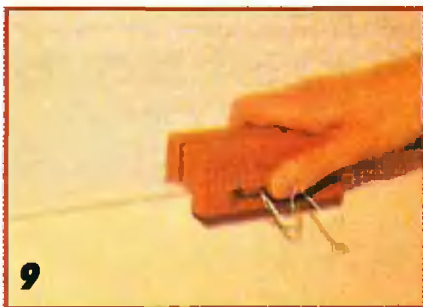
Снятие свесов кромочной обкладки.
