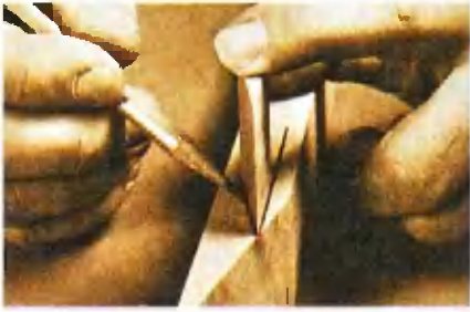
По вспомогательной линии на боковой стороне прикладывают клин и обводят его контур.
