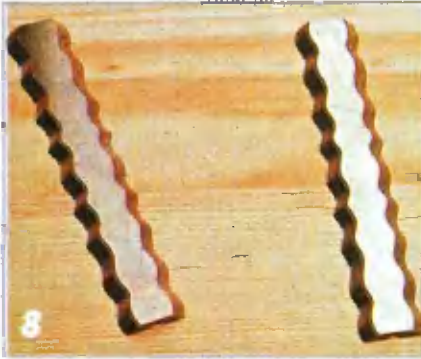
Обе волнообразно заточенные кромки фигурных ножей формируют на обрабатываемой поверхности взаимно параллельные бороздки.
