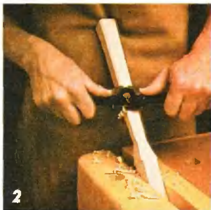
Придать ручке желаемую форму можно обычным скобелем.
