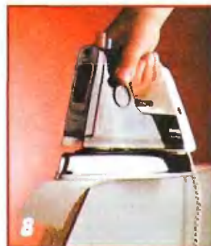
Кромочную обкладку, снабженную с тыльной стороны клеем-расплавом, заглаживают горячим утюгом. Свесы обкладки снимают стамеской.
