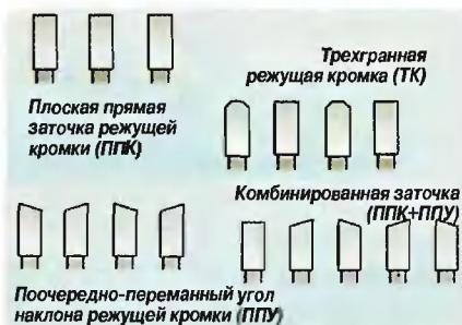
Рис. 2. Четыре типа заточки зубьев.
